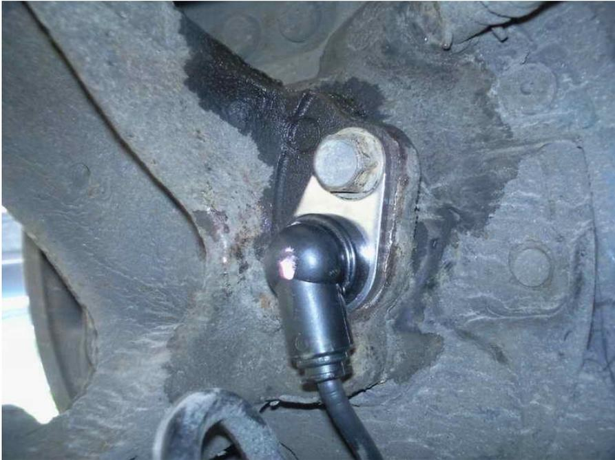
Befestigungsschraube des Sensors lösen und den Sensor versuchen mit einer Zange oder durch hebeln mit einem Schraubendreher aus dem Loch zu ziehen. Das Loch danach mit Caramba oder ähnlichem Einsprühen und den Rost heraus feilen.
