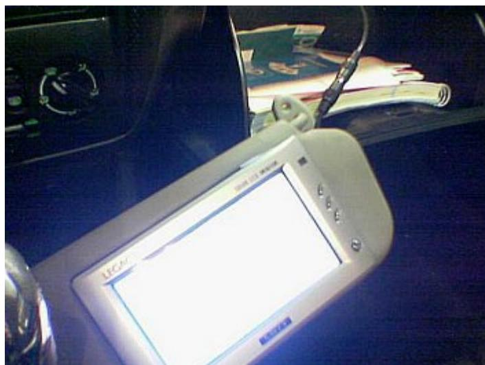
Dann wird der Monitor wieder zugeschraubt und unfixiert eingesetzt. Damit kann ein erster Test im Auto erfolgen.
