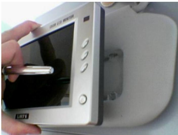
Zuerst legt man den Monitor auf die Blende auf, auf der Position, wo dieser später eingesetzt werden soll. Zu empfehlen ist es, an den Rand des Spiegelfachs anzulegen, dass dieser später durch den Monitor abgedeckt wird.
