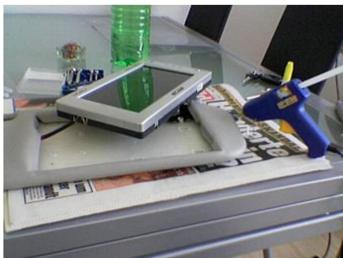
Dann wird das Kabel und der Monitor in die Blende geklebt. Dazu bitte starken PVC Kleber oder am besten Phenolharzkleber verwenden, damit der Monitor nicht irgendwann aus der Blende fällt. ;o)
