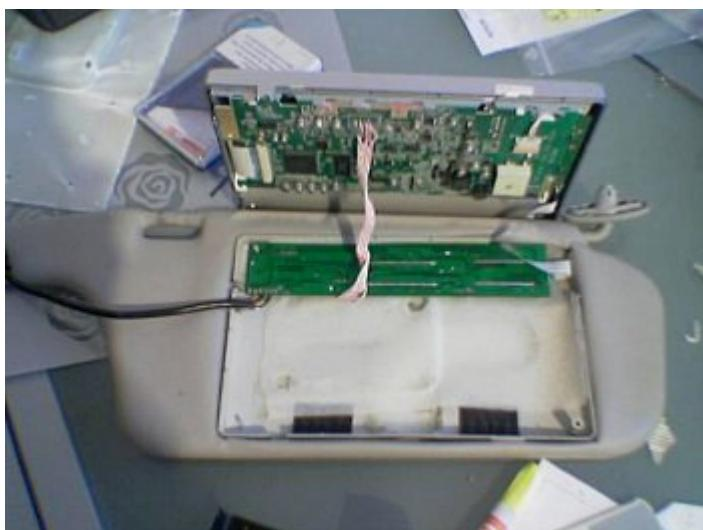
Jetzt geht es daran, das Kabel in der Sonnenblende zu verlegen. Da auf der Unterseite des LCD innerhalb der Sonnenblende nicht genug Platz ist, um das Kabel zu biegen, wird das Gehäuse des LCD geöffnet und das Kabel zur linken Seite verlegt.
