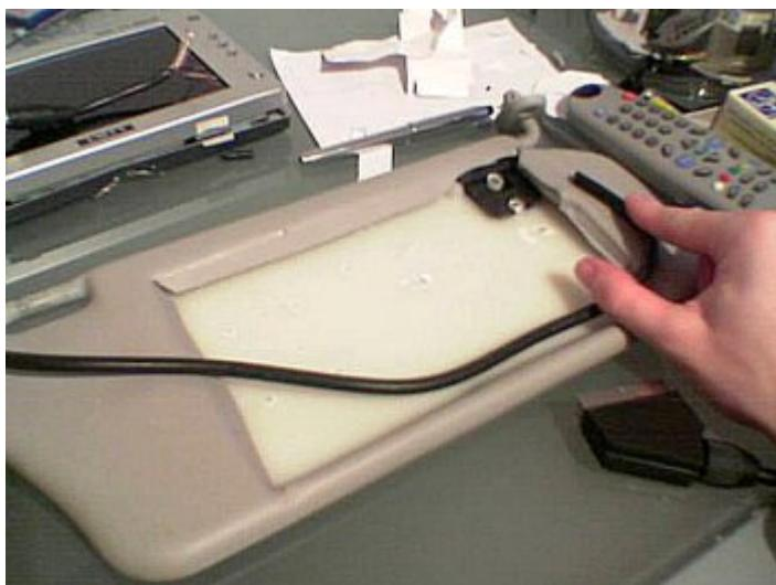
Die benötigte Kabellänge wird in ca. geschätzt (immer lieber etwas mehr nehmen). Das Kabel wird im unteren Rand verlegt, da die Sonnenblende im oberen Rand aufgrund der Metallklammer ungenügend Platz bietet.
