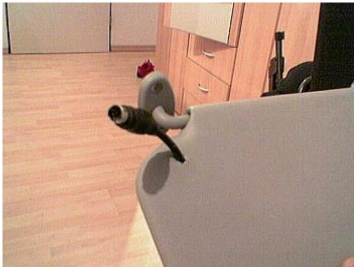
Danach wird das Kabel durch die Sonnenblende gelegt. Zuerst durch das Loch von außen nach innen....
