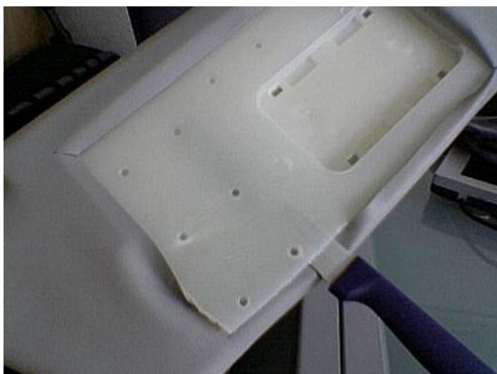
Die Löcher auf der Oberfläche des Plastik sind Verbindungsstücke zwischen der Oberseite und der Unterseite. Diese sind aus Plastik und können ebenfalls geschnitten werden, in dem man mit dem Messer unter das Plastik fährt und an den Stiften ansetzt. Bitte nur vorsichtig schneiden - Rücksicht auf das Leder nehmen.
