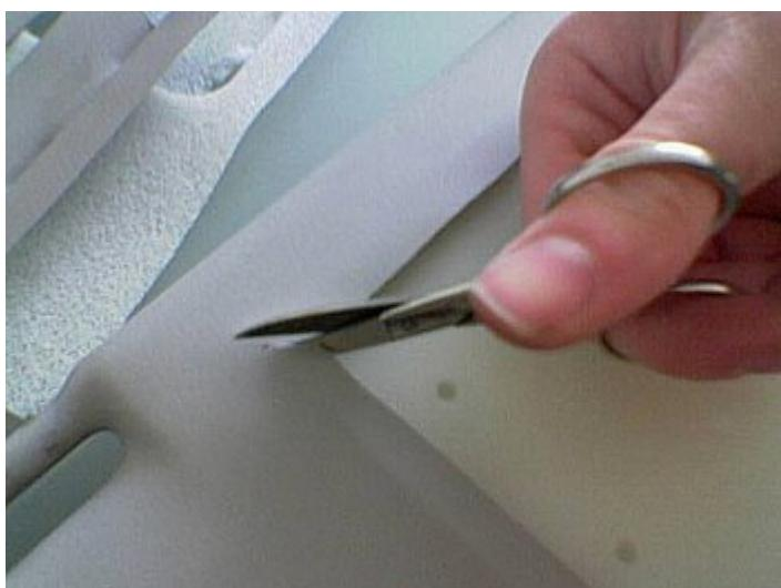
Nun werden die Ecken bis zur äußeren Markierung, die vom LCD Monitor stammt, angeschnitten, sodass auf allen vier Seiten das Leder als Lasche umgelegt werden kann.
