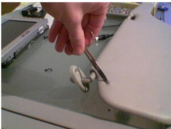
Das Kabel zum Anschluss des Monitor wird nun nach außen verlegt. Dazu wird ein Loch gestochen. Hier an der rechten Außenseite der Blende.
